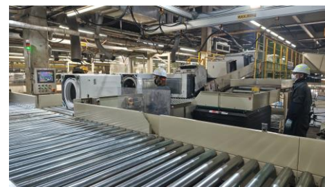
洗濯機搬送ライン
