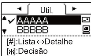
Alterar os separadores conforme necessário usando a tecla [◀] ou [▶] e seleccionar o destinatário pretendido com a tecla [▼] ou [▲].
