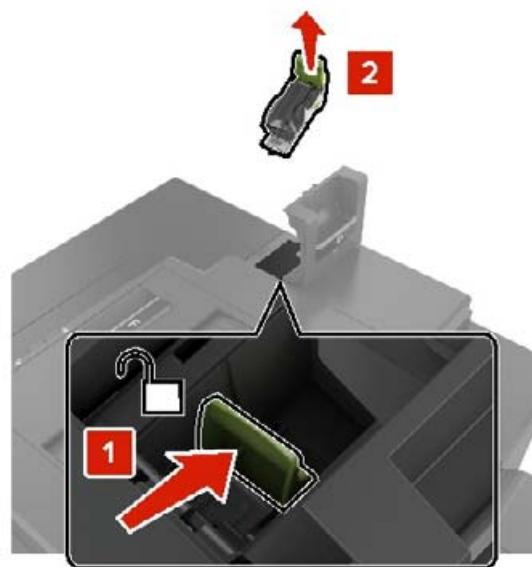
**3** Åbn udløseren til hæfteenheden, og fjern derefter de løse hæfteklammer.
