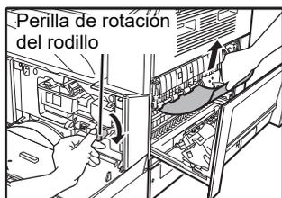
Retire cuidadosamente el papel atascado. Gire el pomo de rotación del rodillo en la dirección de la flecha para ayudar a retirarlo.
