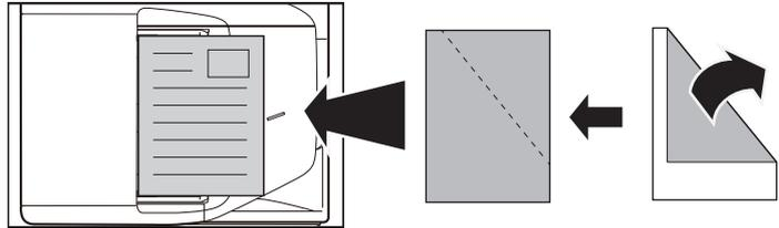
Se l'originale è pinzato, si raccomanda di rimuovere i punti e di smazzare le pagine prima di inserirlo (questo allo scopo di evitare inceppamenti e di strappare l'originale, oltre che per evitare che frammenti di carta rimangano nell'alimentatore).
