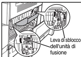
**Rimuovere con cura la carta inceppata. Sollevare le leve di sblocco dell'unità di fusione per agevolare la rimozione.**
