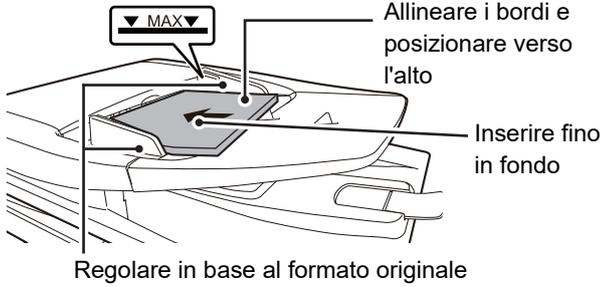
Se l'originale è piegato, eliminare la piega prima di inserirlo. (In questo modo si prevengono gli inceppamenti e gli errori di rilevamento del formato originale)
