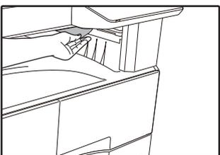
**Riportare la leva del nastro duplex nella posizione originale e chiudere il coperchio laterale.**
