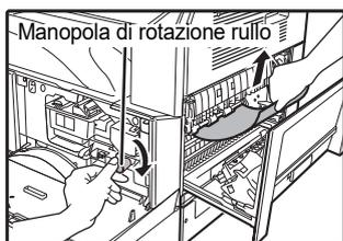
**Rimuovere con cura la carta inceppata. Ruotare la manopola di rotazione rullo in direzione della freccia per facilitare la rimozione.**
