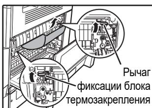
Осторожно извлеките застрявший лист. Поднимите рычаги фиксации блока термозакрепления, чтобы облегчить извлечение.
