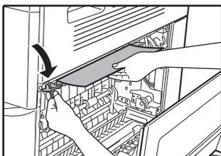
Откройте направляющую бумаги блока термозакрепления, нажав вниз на ее выступающую часть, помеченную зеленым, и извлеките застрявший лист.
