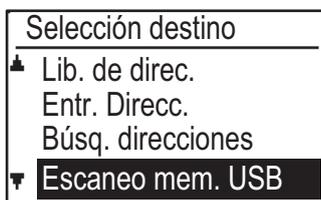
Seleccione "Escaneo mem. USB" con la tecla [▼] y pulse [OK].
