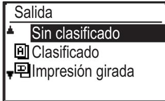
Seleccione "Sin clasificado" o "Clasificado" o "Impresión girada" con las teclas [▼] [▲].
