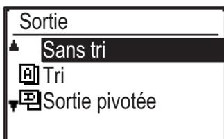
Sélectionnez "Sans tri", "Tri" ou "Sortie pivotée" à l'aide des touches [▼] [▲].
