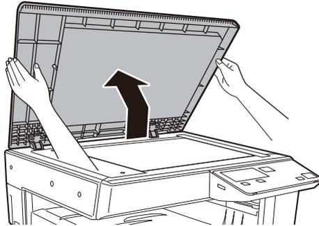
Le chargeur automatique de documents feeder (BP-20M22/BP-21M22/BP-20M24/BP-20M28/BP-20M31) ne peut pas être retiré.
