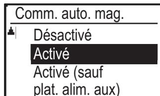
Si vous sélectionnez "Activé (sauf plat. alim. aux)", le papier se trouvant dans un magasin autre que le plateau d'alimentation auxiliaire sera utilisé.
