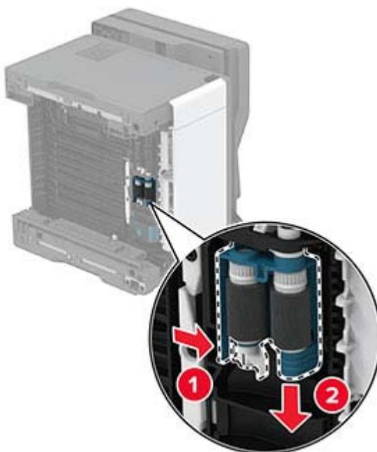
**9** Нанесите изопропиловый спирт на мягкую безворсовую ткань, а затем протрите узел валика захвата.
