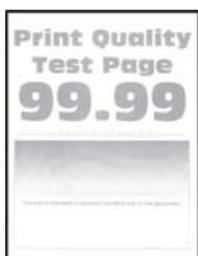
**Примечание:** Перед решением проблемы распечатайте страницы проверки качества печати. На панели управления выберите **Параметры > Поиск и устранение неисправностей > Страницы проверки качества печати**. Для моделей принтеров без сенсорного экрана: нажмите **ОК** для перемещения между параметрами.
