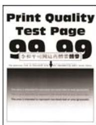
**Примечание:** Прежде чем приступить к решению проблемы, распечатайте страницы проверки качества печати. На панели управления выберите **Параметры > Поиск и устранение неисправностей > Страницы проверки качества печати**. При использовании моделей принтеров без сенсорного экрана нажимайте **OK** для перемещения между параметрами.
