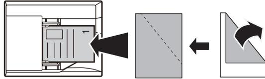
Se l'originale è pinzato, si raccomanda di rimuovere i punti e di smazzare le pagine prima di inserirlo (questo allo scopo di evitare inceppamenti e di strappare l'originale, oltre che per evitare che frammenti di carta rimangano nell'alimentatore).
