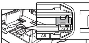
Se la macchina non riconosce il formato della carta nonostante siano caricati correttamente il tipo A4 nel vassoio 1 o il tipo 8-1/2" x 14" nei vassoi da 2 a 4, controllare se il fermo nella cassetta è posizionato su A4 (o 8-1/2" x 14" nei vassoi da 2 a 4).
