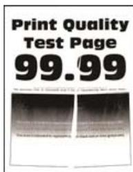
**Remarque :** Avant de résoudre le problème, imprimez les pages de test de qualité d'impression. Sur le panneau de commandes, accédez à **Paramètres > Dépannage > Pages de test de qualité d'impression**. Sur les modèles d'imprimante sans écran tactile, appuyez sur
