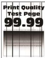
**Remarque :** Avant de résoudre le problème, imprimez les pages de test de qualité d'impression. Sur le panneau de commandes, accédez à **Paramètres > Dépannage > Pages de test de qualité d'impression**.
