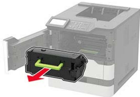
3 Entfernen Sie die Belichtungseinheit.
