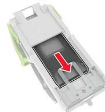
**Hinweis:** Wenn sich die Heftklammern an der Rückseite der Tonerkassette befinden, schütteln Sie die Kassette nach unten, um die Heftklammern in die Nähe der Metallhalterung zu bringen.
