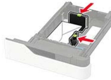
**Warnung—Mögliche Schäden:** Es dürfen keine Umschläge mit Briefmarken, Metallklammern, Haken, Fenstern, Fütterung oder selbstklebenden Klebeflächen verwendet werden.
