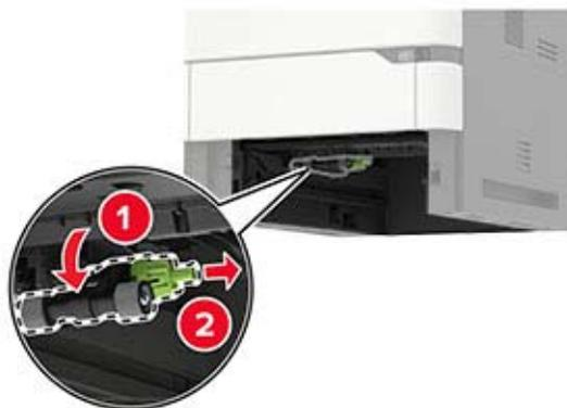
4 A l'aide d'un chiffon doux, humide et non pelucheux, nettoyez les rouleaux d'entraînement.
