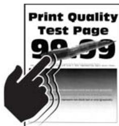
**Remarque :** Avant de résoudre le problème, imprimez les pages de test de qualité d'impression. Sur le panneau de commandes, accédez à **Paramètres > Dépannage > Pages de test de qualité d'impression**. Sur les modèles d'imprimante sans écran tactile, appuyez sur **OK** pour parcourir les paramètres.
