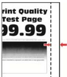
**Remarque :** Avant de résoudre le problème, imprimez les pages de test de qualité d'impression. Sur le panneau de commandes, accédez à **Paramètres > Dépannage > Pages de test de qualité d'impression**. Sur les modèles d'imprimante sans écran tactile, appuyez sur **OK** pour parcourir les paramètres.
