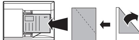
Si l'original est agrafé, assurez-vous de retirer les agrafes et de bien aérer les pages avant de le charger. (Ceci évite une mauvaise alimentation et le déchirement de l'original, ainsi que des morceaux déchirés de l'original de rester dans le chargeur.)
