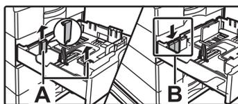
Lorsque vous réglez un format papier d'une largeur de 8-1/2", retirez les 2 plaques de régulation (A) avec du vert à l'avant et à l'arrière du magasin avant de régler le format papier. Les plaques sont rangées dans l'espace de stockage intérieur (B) à l'arrière du magasin.
