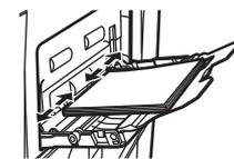
Réglez les guides du plateau d'alimentation auxiliaire de sorte qu'ils soient légèrement en contact avec le papier chargé.
