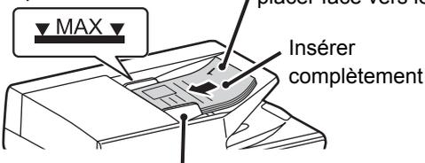
Si l'original est plié, aplatissez-le avant de le charger. (Cela évite les mauvaises alimentations.)
