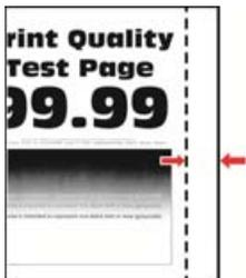
**Hinweis:** Drucken Sie die Testseiten, bevor Sie das Problem beheben. Navigieren Sie auf dem Bedienfeld zu **Einstellungen > Fehlerbehebung > Testseite drucken**. Drücken Sie bei Druckermodellen ohne Touchscreen
