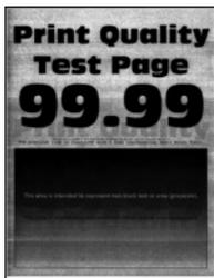
**Hinweis:** Drucken Sie die Testseiten aus, bevor Sie das Problem beheben. Navigieren Sie auf dem Bedienfeld zu **Einstellungen > Fehlerbehebung > Testseite drucken**. Drücken Sie bei Druckermodellen ohne Touchscreen
