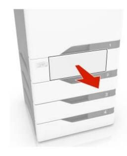
Advertencia: Posibles daños: Un sensor dentro de la bandeja opcional se daña fácilmente con la electricidad estática. Toque una superficie metálica antes de retirar el papel atascado en la bandeja.
