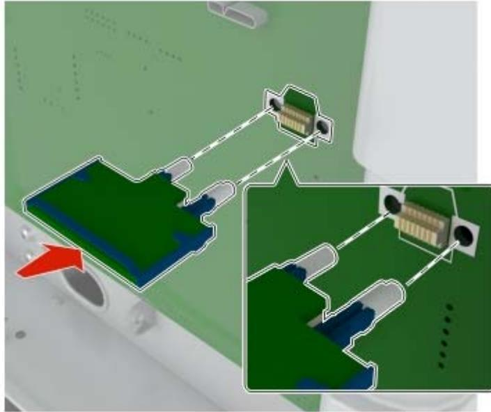
**Hinweis:** Der Steckverbinder auf der Karte muss über die gesamte Länge bündig an der Controller-Platine anliegen.
