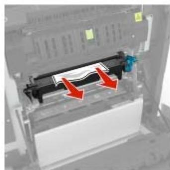
**3** Åpne dekselet til fikseringsenheten.
