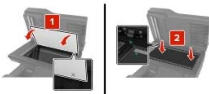
**5** Закройте крышку сканера, чтобы прокладка сканирования УАПД приклеилась к крышке.
