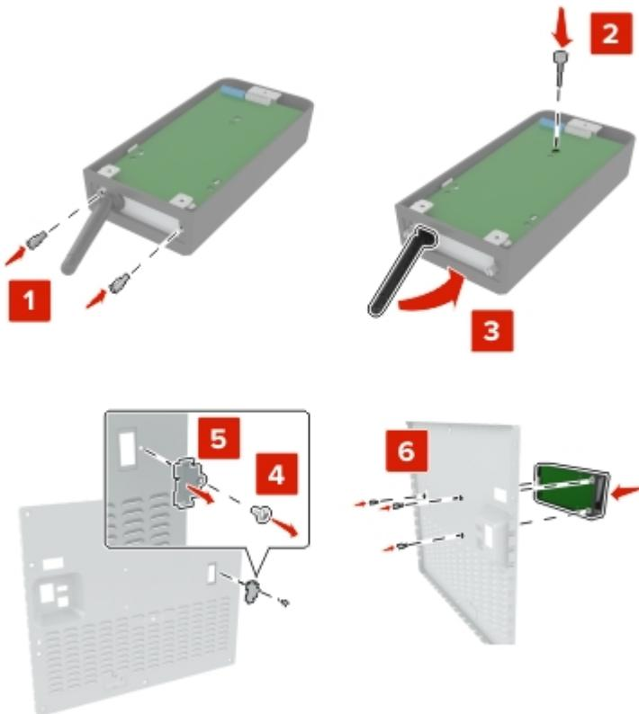
6 Подключите удлинительный кабель ISP к разъему ISP на системной плате.
