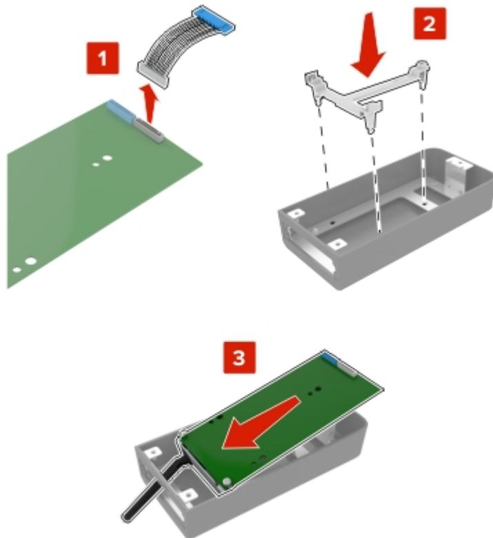
5 Прикрепите корпус к крышке доступа к системной плате.
