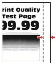
**Примечание:** Перед решением проблемы распечатайте страницы проверки качества печати. На панели управления перейдите к **Параметры > Поиск и устранение неисправностей > Печать страниц проверки качества**. Для моделей принтеров без сенсорного экрана: нажмите **OK** для перемещения между параметрами.
