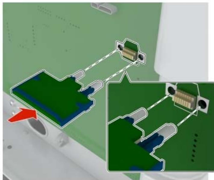
**Примечание:** Разъем платы микропрограммного обеспечения должен соприкасаться с системной платой по всей длине и располагаться в одной плоскости с ней.
