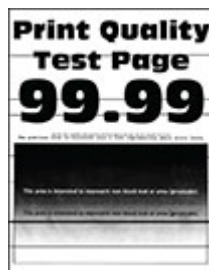
Vannrette mørke streker på side 120
