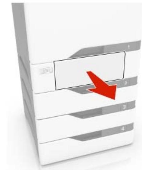
**Avertissement—Danger potentiel :** Un capteur dans le tiroir facultatif peut facilement être endommagé par l'électricité statique. Touchez une surface métallique avant de retirer le papier coincé dans le tiroir.
