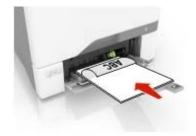
• Legen Sie Briefumschläge so ein, dass die Umschlagklappe nach oben und zur rechten Seite der Papierführung zeigt. Legen Sie europäischen Umschläge mit der Klappe zuerst in den Drucker ein.
