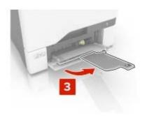
2 Passen Sie die Führung so an, dass sie dem Format des eingelegten Papiers entspricht.
