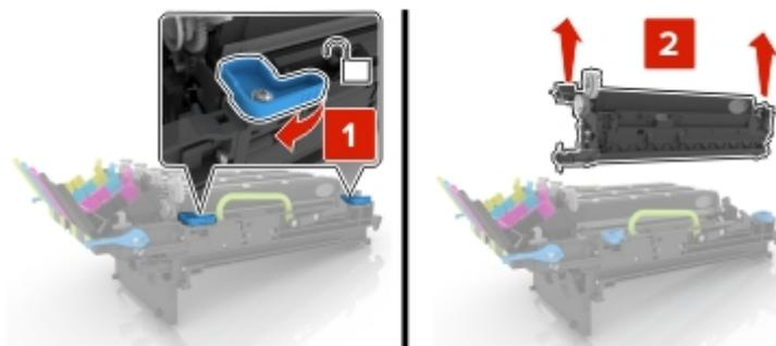
**Nota:** l'unità di imaging nero include l'unità sviluppatore nero e l'unità fotoconduttore.
