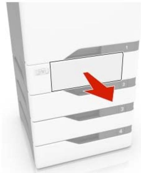
**Attenzione - Possibili danni:** un sensore all'interno del vassoio opzionale viene facilmente danneggiato dall'elettricità statica. Prima di rimuovere la carta inceppata nel vassoio, toccare una superficie metallica.
