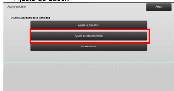
2) Para imprimir un parche de prueba, toque la tecla [Ejecute] en la pantalla Ajuste Desigualdad de densidad (Ajuste del densitómetro). Si necesita cambiar la densidad, seleccione la densidad deseada y luego toque la tecla [Ejecute].
