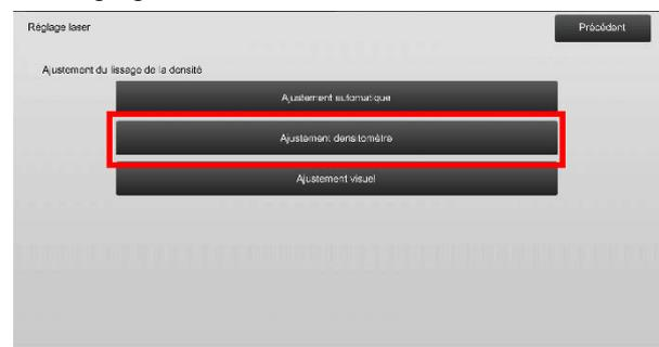
2) Pour imprimer une mire de test, appuyez sur la touche [Soumettre] sur l'écran Réglage de l'uniformité de la densité (Réglage par densitomètre). Si vous devez modifier la densité, sélectionnez la densité souhaitée, puis appuyez sur la touche [Soumettre].
