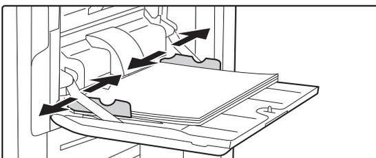
**Ajuste las guías de la bandeja bypass correctamente a la anchura del papel.**
