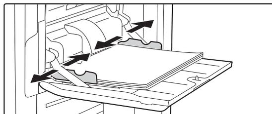
將手送台導板正確設為紙張寬度。
