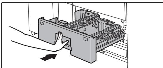
**放下送紙滾輪，並將紙盤輕輕推入機器。**
